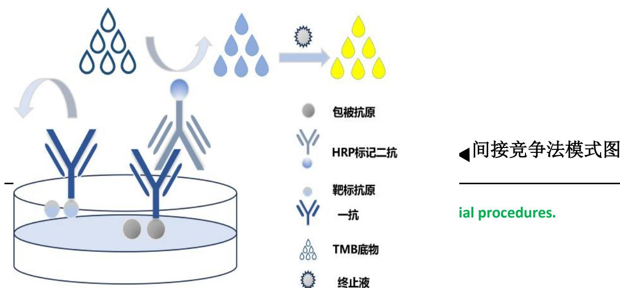
按操作顺序形成包被抗原-抗体-酶标二抗复合物后，加入TMB 底物，板孔液体由无色变成蓝色，再加入终止液液体变为黄色后进行吸光度值测定。
